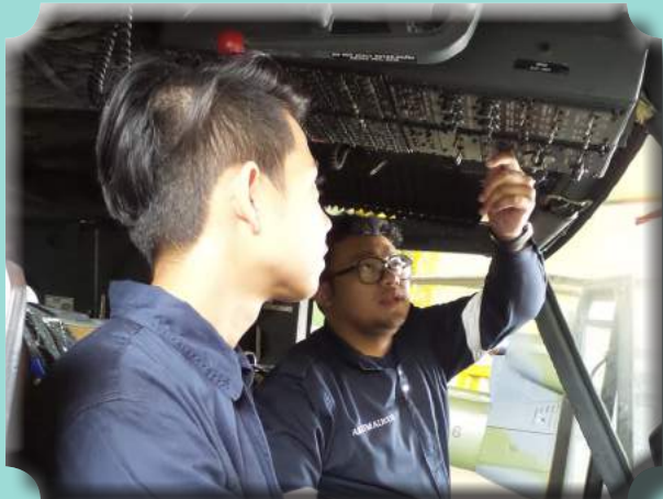
Pelajar program HNTec in Aircraft Maintenance Engineering sedang menjalankan pemeriksaan lampu Helikopter Bell 212
